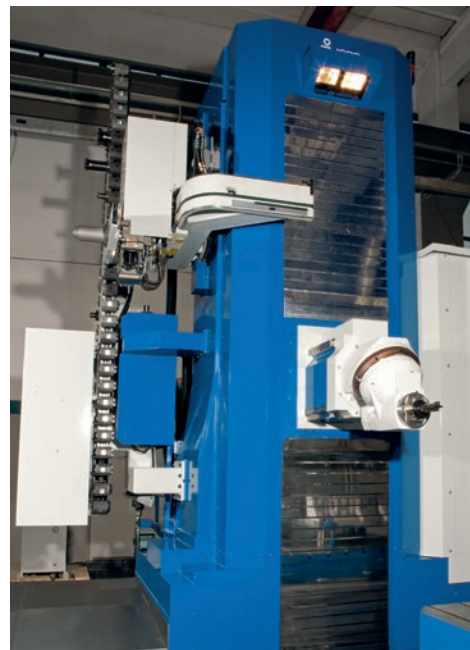
Magazzino utensili a catena a 40/60 posti ISO 50/HSK-A-100
