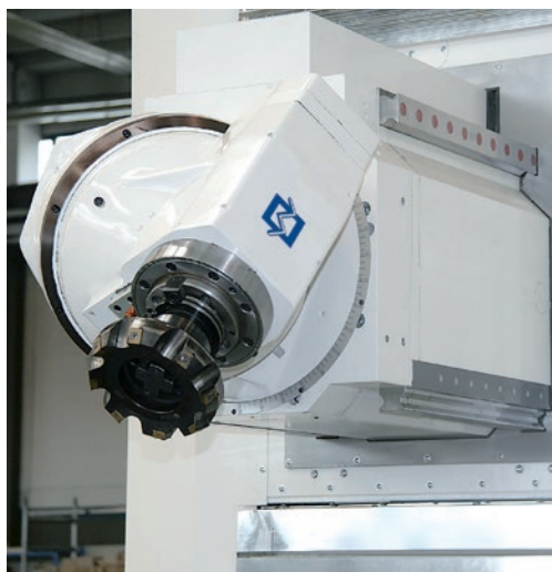
Testa universale di fresatura ad alta rigidità (potenza 44 kW)
