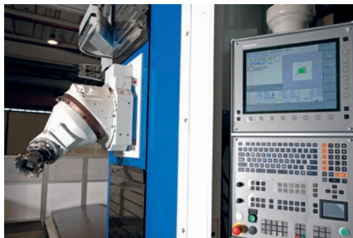
Sistema di programmazione/MDI in assi polari reali per testa di fresatura indexata
