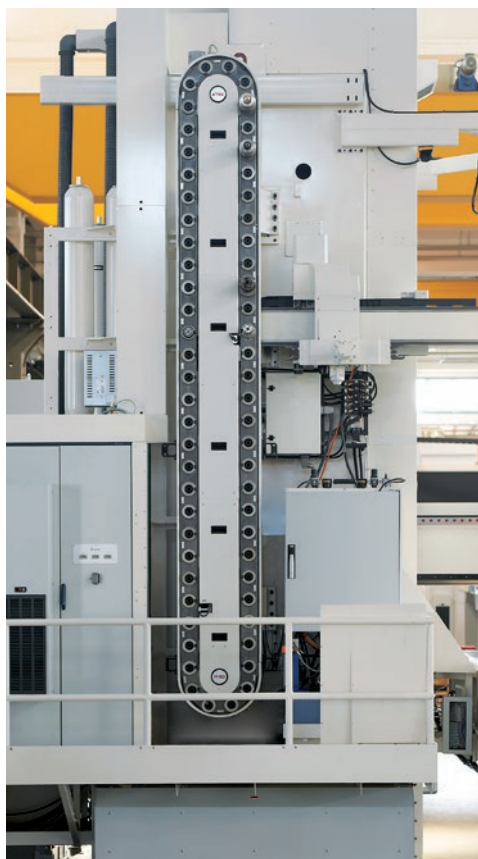
Magazzino utensili a catena a 40/60 posti ISO 50/HSK-A-100
