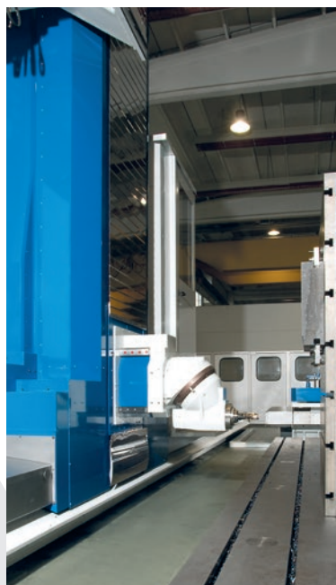
Design ottimizzato per garantire la minima distanza (738 mm) fra naso mandrino e filo pavimento
