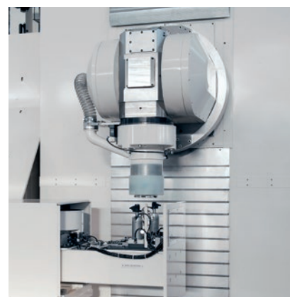
Gruppo di aspirazione polveri al mandrino ad alta efficienza con opzione di cambio cappa automatico e magazzino cappe
