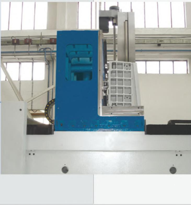
I cinematismi degli assi sono stati progettati per garantire elevate accelerazioni e velocità. L'asse gantry è azionato da viti a ricircolo di sfere per corse fino a 4000 mm. Per corse superiori sono utilizzati sistemi dual-drive con pignoni e cremagliere. Gli altri 2 assi lineari sono azionati da viti a ricircolo di sfere.
