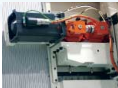
Meccanismo ad alta velocità doppio pignone-cremagliera.
