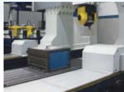
Protezioni assi X e Y con coperture avvolgibili (pedonabili per asse X).
