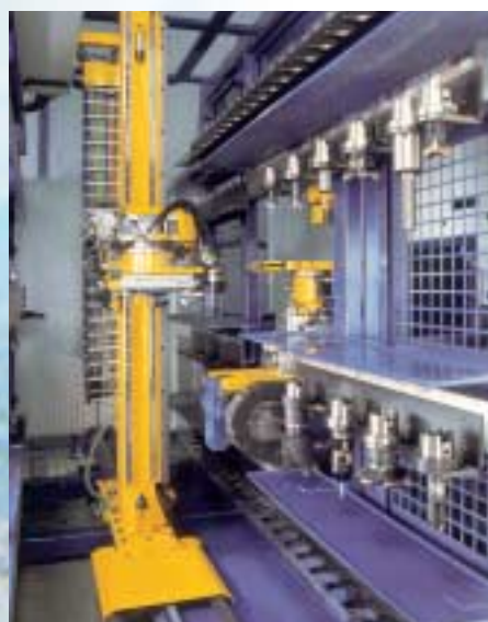
Magazzino utensili modulare a rack (HSK-A-100) ad ampia capacità, predisposto per teste twist e teste angolari.
