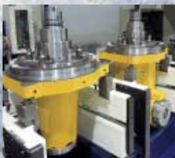
Cambio automatico teste di fresatura BUSS.
