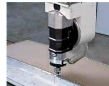
Sulle teste è possibile integrare un sistema di aspirazione sviluppato da Jobs, dotato di cappa mobile a movimento programmabile. Tale soluzione garantisce la massima efficienza di aspirazione delle polveri in tutta l'area di lavoro
