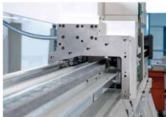
Struttura asse longitudinale (asse X), ottimizzata per il miglior compromesso tra dinamica, precisione e rigidità asse
