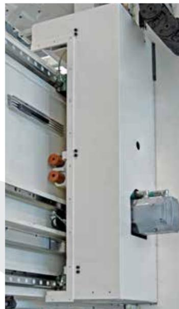
Struttura asse trasversale (asse Y) composta da una traversa in carpenteria elettrosaldata con due guide a rulli precaricati per lo scorrimento del carro asse Y
