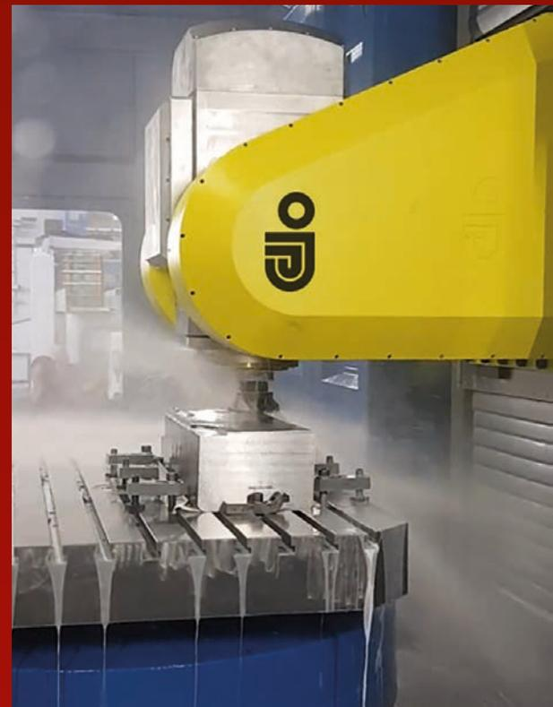
*L'elettromandrino è stato progettato da Jobs per sviluppare 1.210 Nm di coppia e 96 kW di potenza e può raggiungere i 4.000 giri/min*
