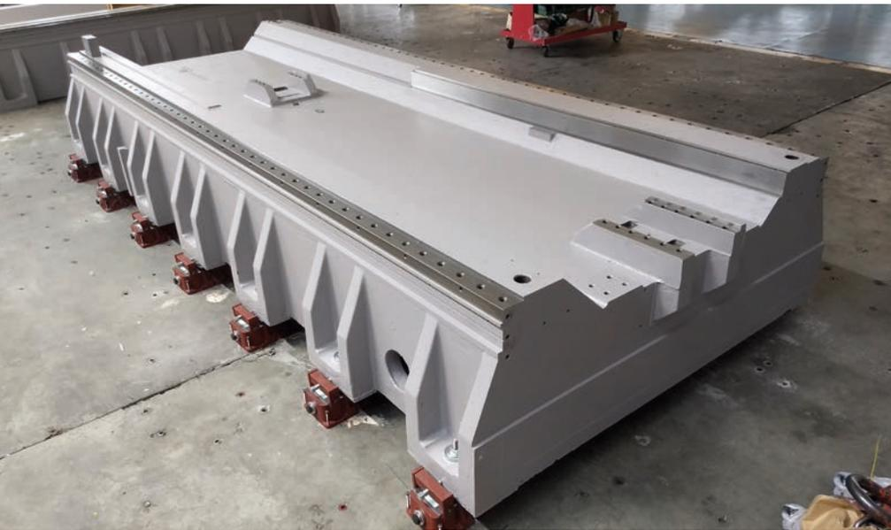
La struttura in ghisa permette di assorbire al meglio le vibrazioni indotte dal processo di fresatura
